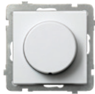
ŁP-8RL2/m/00 2006 Ściemniacz uniwersalny zakres obciążenia: GLS 10-250W, CFL 5-75W, LED 0-100W, funkcja wyłącznika czasowego i „time to bed”
