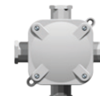
ONH-4B5 Odgałęźnik instalacyjny ścienny - 4x4mm 2 , 4-wylotowy, 5-torowy, dławnice gwintowe, IP-67
