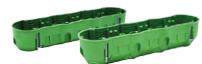
PP-F4x60PŁ.REG-N / PP-F4x60GŁ.REG-N Puszka instalacyjna, końcowa, poczwórna z wkrętami, do ścian pustych, płytka 4xØ60, głębokość: 45mm/ głęboka 4xØ60, głębokość: 60mm
