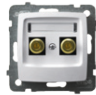
GGN-1S/m/00 1573 Gniazdo głośnikowe, pojedyncze przyłączalność przewodów 6 mm 2
